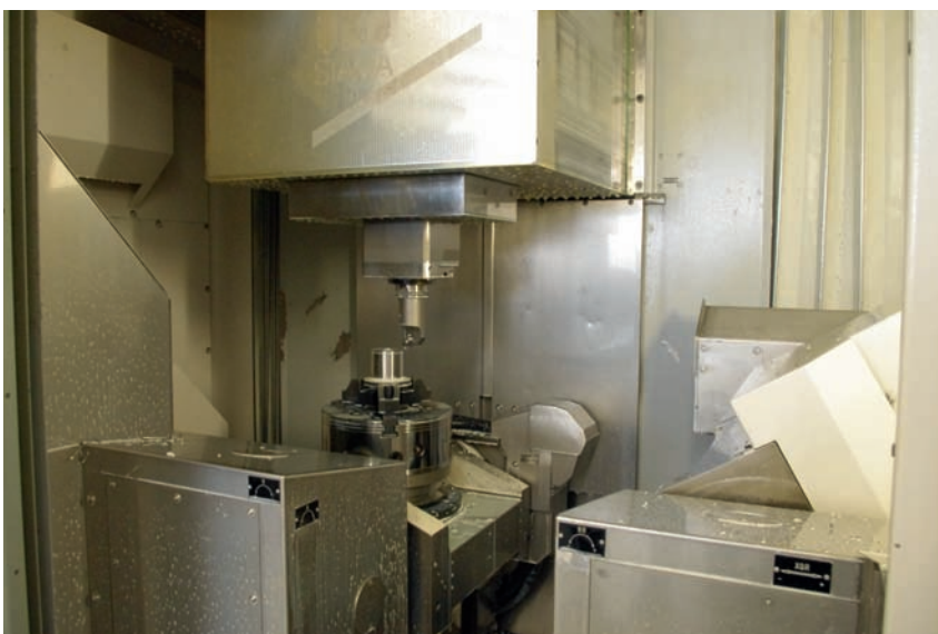
3 Drehen einer Außenkontur an einem kurzen, im Futter gespannten Flanschwerkstück auf der linken Drehspindel
