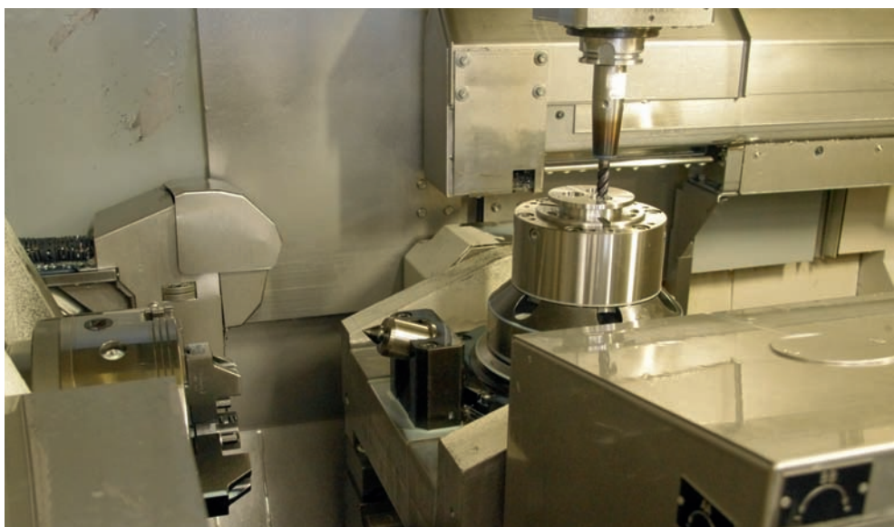
1 Auf einem Fräsdrehzentrum MC 734/MT von Stama stellt Veldener schnell und flexibel Prototypen und Vorserien in Komplettbearbeitung her
