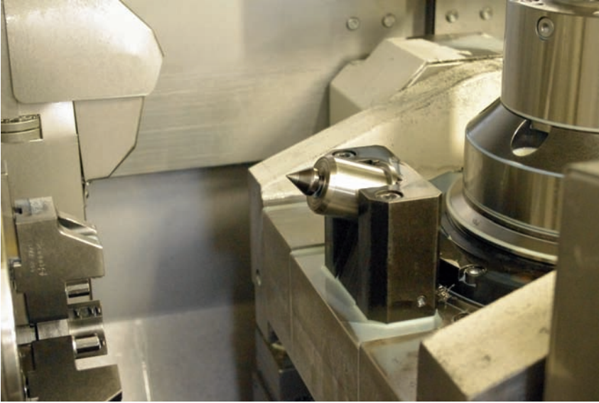
4 Für hohe Genauigkeiten stützt eine mitlaufende Spitze auf der rechten Schwenkachse bis zu 400 mm lange Drehteile beim Längsdrehen sowie radialen Bohren und Fräsen
