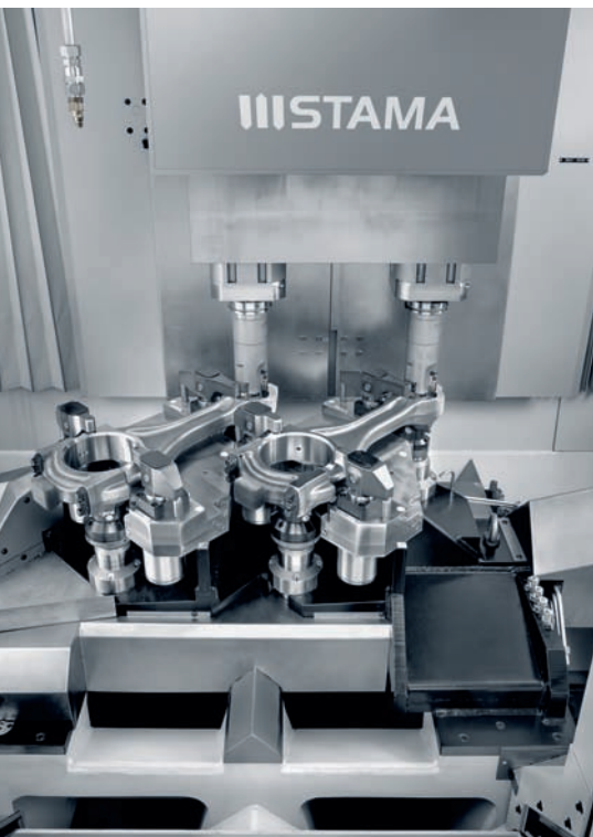
3 Doppelspindlige Feinbearbeitung von Pleueln mit HSK-A100. Geforderte Präzision: 5 µm
