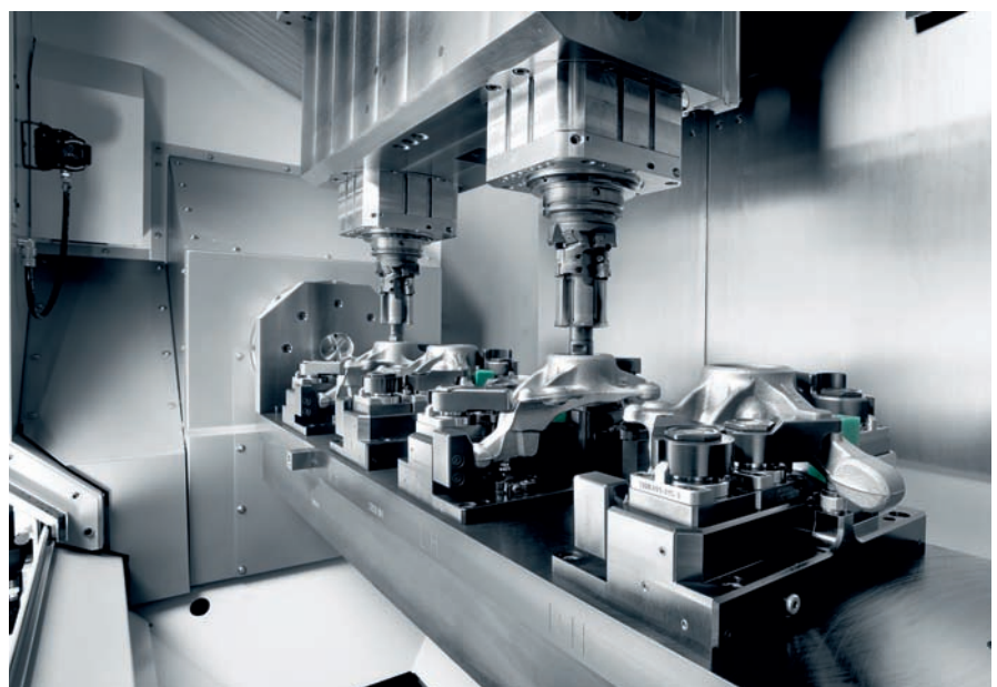
2 Doppelspindlige Schwerzerspanung von Radträgern. Komplettbearbeitung in zwei Spannlagern auf einem Zweiplatz-Zentrum. Dynamische Serienfertigung mit 2-plus-4-Konzept
