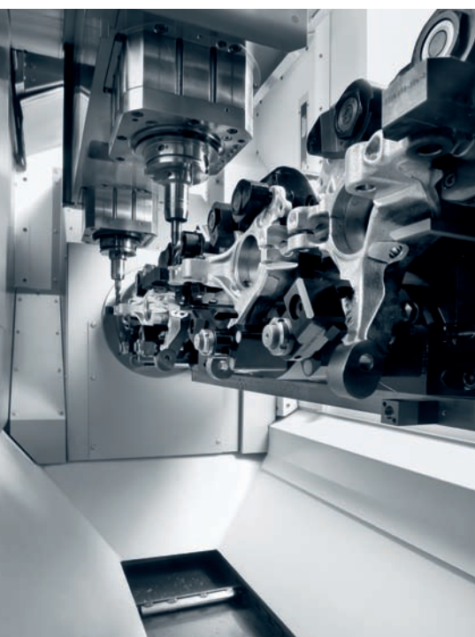
2 Doppelspindlige Schwerzerspanung von Radträgern. Komplettbearbeitung in zwei Spannlagern auf einem Zweiplatz-Zentrum. Dynamische Serienfertigung mit 2-plus-4-Konzept
