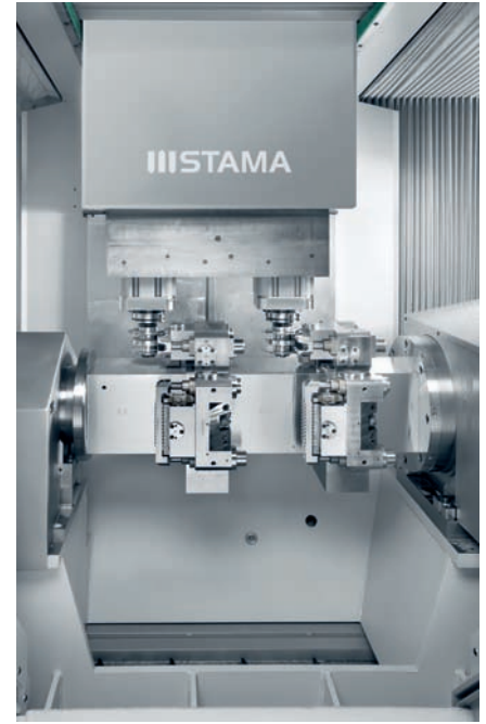
4 Hochproduktive Schwerzerspannung von Kerbschlagproben mit hauptzeitparallelem Be- und Entladen auf einem Twin-Zweiplatz-Zentrum
