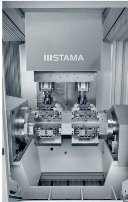
4 Hochproduktive Schwerzerspannung von Kerbschlagproben mit hauptzeitparallelem Be- und Entladen auf einem Twin-Zweiplatz-Zentrum
