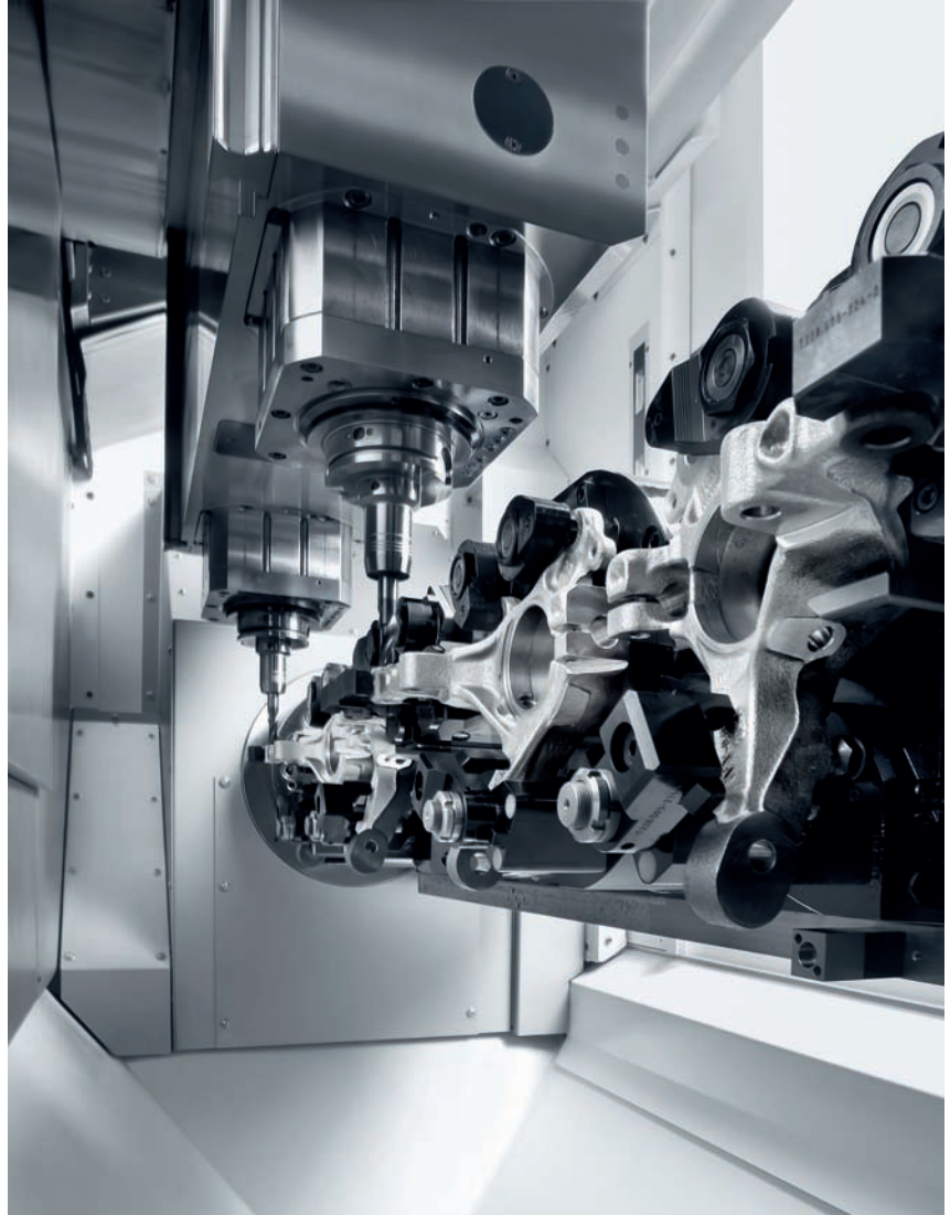
1 Typisch Stama: Die MC 536 Twin ist ein doppelspindliges BAZ für die Komplettbearbeitung großer Werkstücke in Serie
