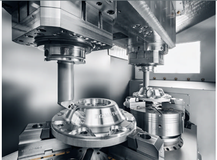
4 Doppelspindlige Drehbearbeitung: Für ein hochgenaues Bearbeitungsergebnis der kombinierten Fräs- und Drehbearbeitung sorgt die sensorisch überwachte Positioniergenauigkeit der Drehspindeln zu den Frässpindeln
