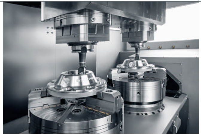
3 Doppelspindlige HPC-Fräsbearbeitung: Bei zunehmend schwer zerspanbaren Hochleistungswerkstoffen schöpft die MT 838 Twin das Potenzial moderner Präzisionswerkzeuge voll aus
