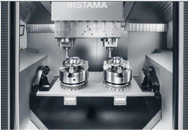
2 Kraftvoll und dynamisch schwerzerspanen in höchstmöglicher Präzision: Die MT 838 ermöglicht das doppelspindlige Fräsen und Drehen im Sinne der Komplettbearbeitung in einer Aufspannung
