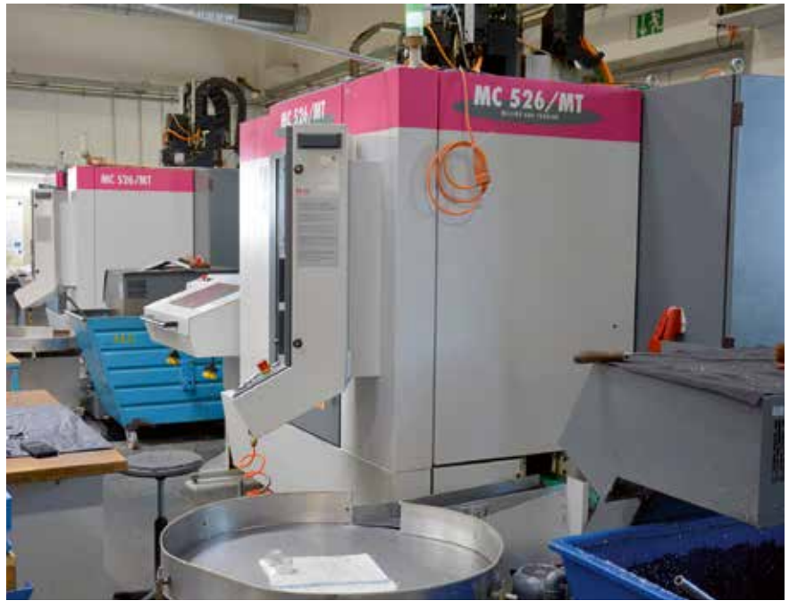
4 Automatisiert dank Stangenlader und Fertigteile-Rundspeicher: Den Einstieg in die Fräsdrehtechnik mit MT-Maschinen von Stama kombinierte Kögel mit der Arbeit von der Stange und eigenentwickelten Automationslösungen für mannlose Geisterschichten (© Hanserl)
