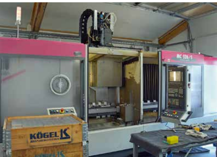
3 Wegbereiter: Mit dem vierachsigen Fahrständer-BAZ MC 526/S zur nebenzeitarmen Pendelbearbeitung in zwei Arbeitsräumen kam Kögel 2001 auf den Stama-Geschmack
