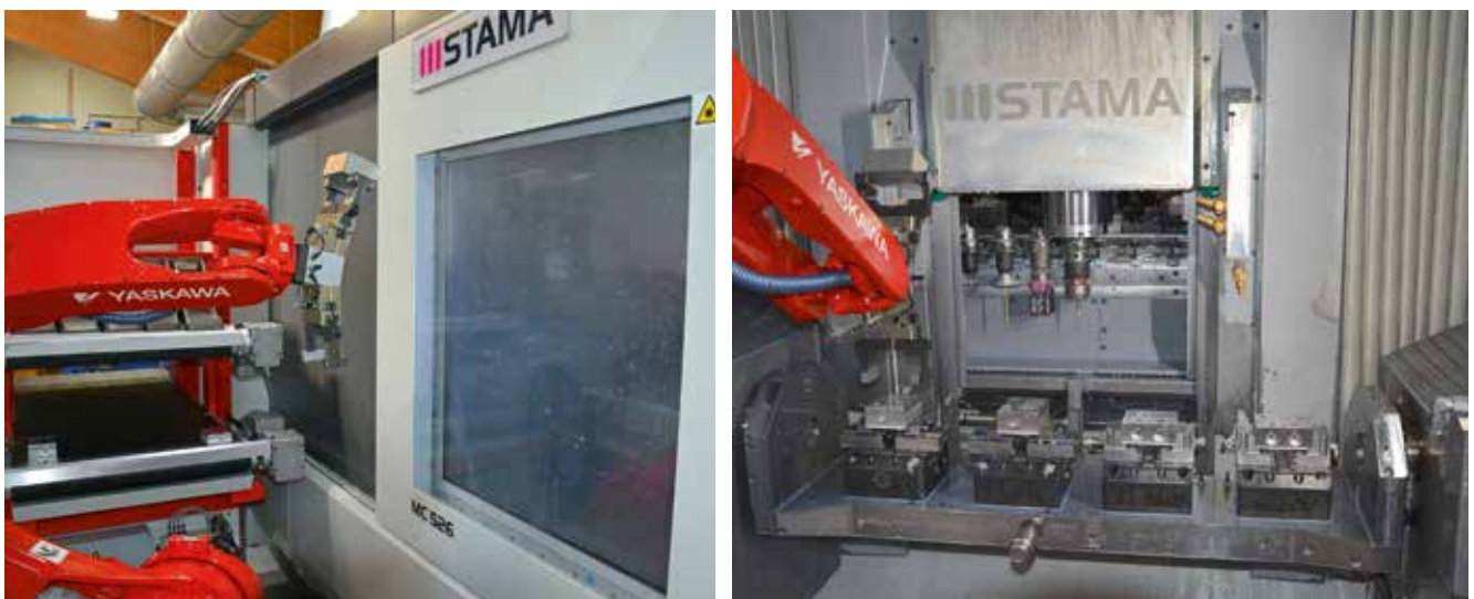
5 Roboterzelle mit geringen Rüstzeiten, wirtschaftlich ab kleineren bis mittleren Losgrößen: MC 526 von Stama mit FMB-Unirobot für die Komplettbearbeitung von Einlegeteilen in Mehrfachspannung (© Hanserl)
