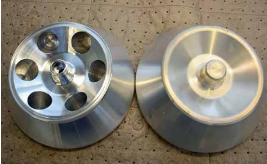
2 Festwinkelrotor Roh- und Fertigteil: Bei diesen variantenreichen Schmiedeteilen aus hochfester Aluminiumlegierung werden auf den Stama-Fräsdrehzentren bei Eppendorf in zwei Aufspannungen über 80 Prozent der Rohmasse in Späne verwandelt (© Hanser)
