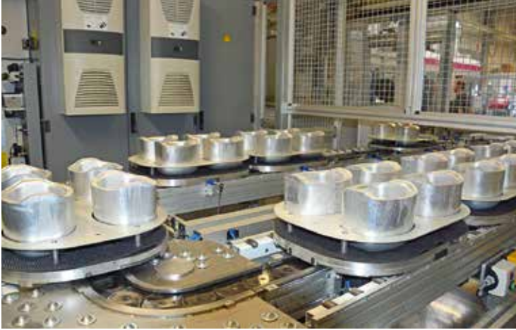
3 Chargen-Aufnahmebecher – Rohteile und Fertigteile im Ausschwingrotor: Die Rohlinge werden über ein Palettenband mit Auflegeschablone lageorientiert zur Komplettbearbeitung dem Stama-Fräsdrehzentrum zugeführt (© Hanser)
