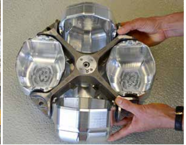
3 Chargen-Aufnahmebecher – Rohteile und Fertigteile im Ausschwingrotor: Die Rohlinge werden über ein Palettenband mit Auflegeschablone lageorientiert zur Komplettbearbeitung dem Stama-Fräsdrehzentrum zugeführt (© Hanser)
