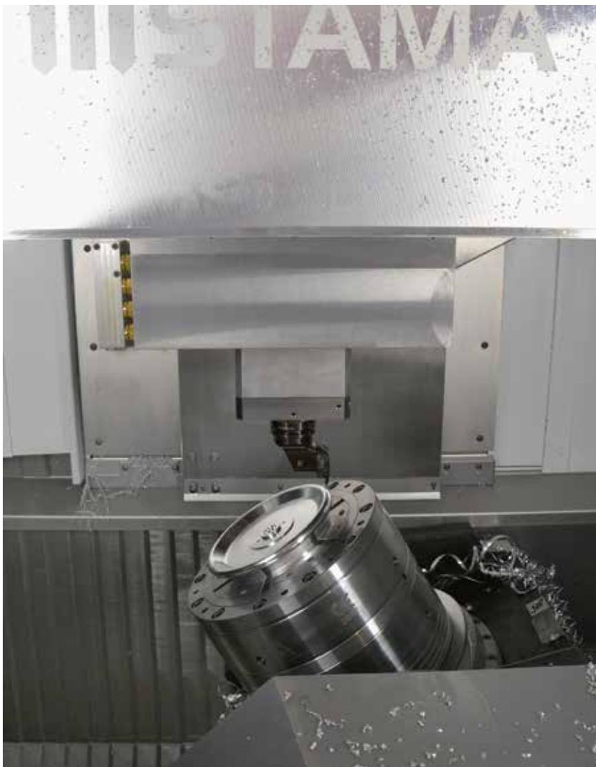
1 Arbeitsraum einer MT 734 2C: Die schwenkbare Drehspindel unten übernimmt im Rahmen der 5-Achs-Bearbeitung die Werkstückausrichtung, wohingegen das Werkzeug stets vertikal von oben zustellt (© Hanser)
