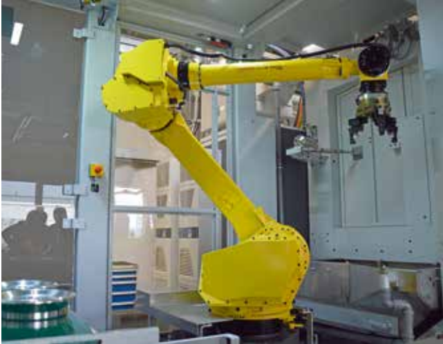
5 7-Achs-Roboter in der HandlingTech-Zelle: Dank Fanuc-Vision-Kamera können bis zu 118 Rohteile nach optischem Scannen lageorientiert der Maschine zugeführt werden – optimal auch für den bedienerlosen Wochenendbetrieb |© Hanser|
