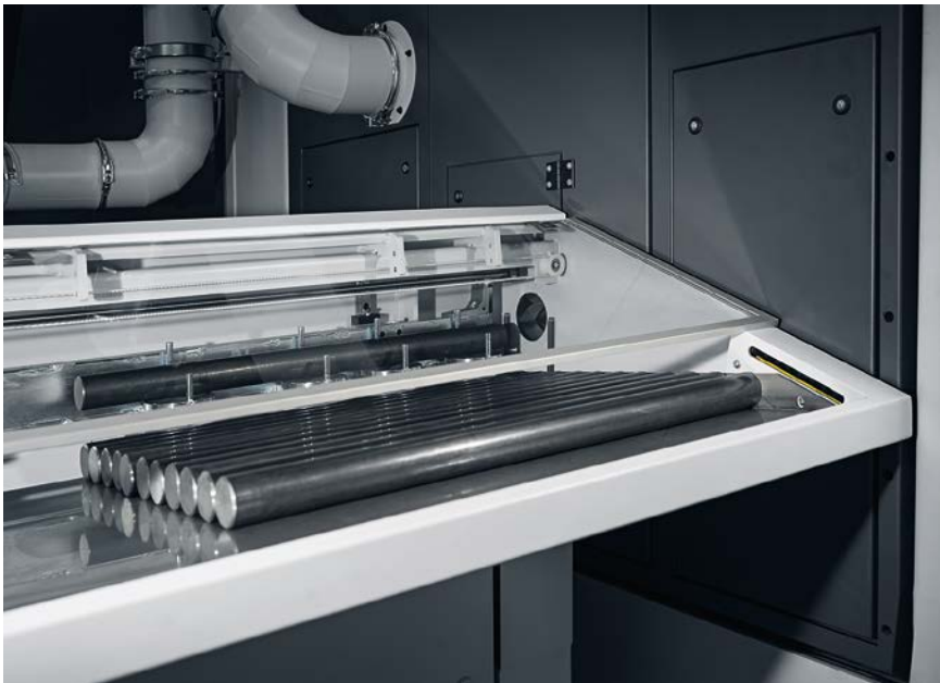
6 Das Maximum herausholen: Stama setzt auch künftig auf Kurzstangen (1 m lang, bis 102 mm Durchmesser) und schwenkt diese mithilfe der Drehspindel (B-Achse); für noch mehr Power und Präzision bei der simultanen 5-Achs-Zerspanung sorgt erstmals ein Galaxie-Getriebe von Wittenstein [© Stama]
