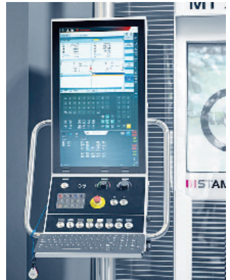
Bild 4. Das „digitale Gesicht“ der neuen MT-Baureihe ist das „TouchLine“-Bedienpult.
