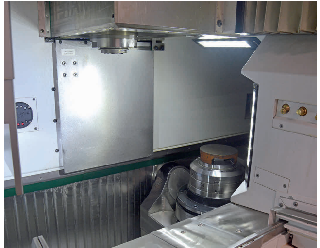
3 Geteilter Arbeitsraum der MT 733 two: Links das Rohteil, das mittels Schwerzerspannung gedreht und gefräst wird; nach der hochgenauen Übergabe erfolgt die äußerst präzise Bohrbearbeitung auf der Rückseite (rechts) (© Hanser)
