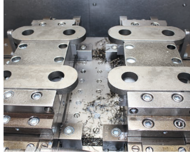
Die Spannvorrichtung wird außerhalb der Maschine bestückt und nimmt maximal vier Kettenlaschen auf.
