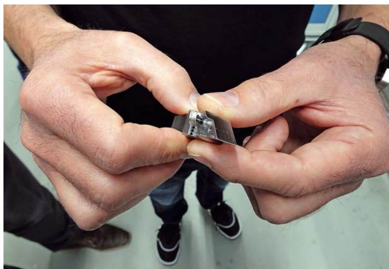
Die Position der inneren Kühlmittelzuführung zeichnet die Arno-Werkzeuge besonders aus und stellt hohe Anforderungen an die Fertigung.
