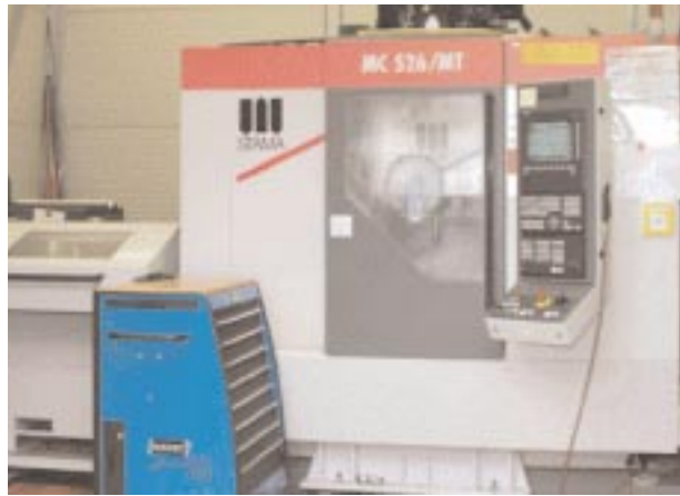
Das Fräs-Dreh-Zentrum Stama MC 526/MT ermöglicht in einer Aufspannung die 5-Seiten-Bearbeitung des Stangenmaterials, dann wird das Werkstück abgegriffen, von der Stange getrennt und auf der verbleibenden sechsten Seite fertigbearbeitet.
