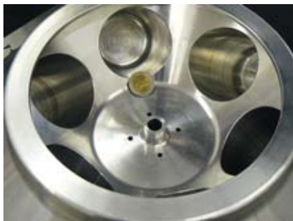
In die Vollen: Die Durchmesser der Rotoren variieren zwischen 170 und 450 mm; die Unterseite wird fünfachsig simultan bearbeitet.
