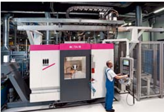
Das 5-Achs-Fräszentrum für die Stangenbearbeitung MC 734/M ist – in verschiedenen Ausbaumformen – zum Standardsystem für die Sonderwerkzeugefertigung bei Sandvik geworden
