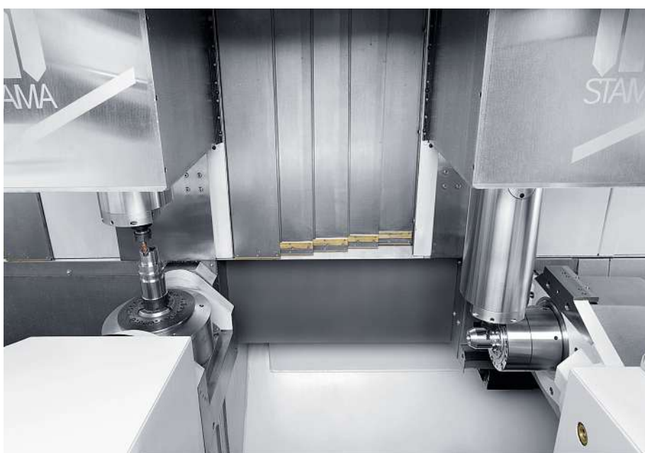
Bild 1: Im Innenraum der Maschine sorgen zwei unabhängige Fahrständer für zeitparallele Bearbeitung. Links: Bearbeitung der Seiten 1 bis 5, rechts: Bearbeitung der Seiten 2 bis 6 des Werkstücks.
