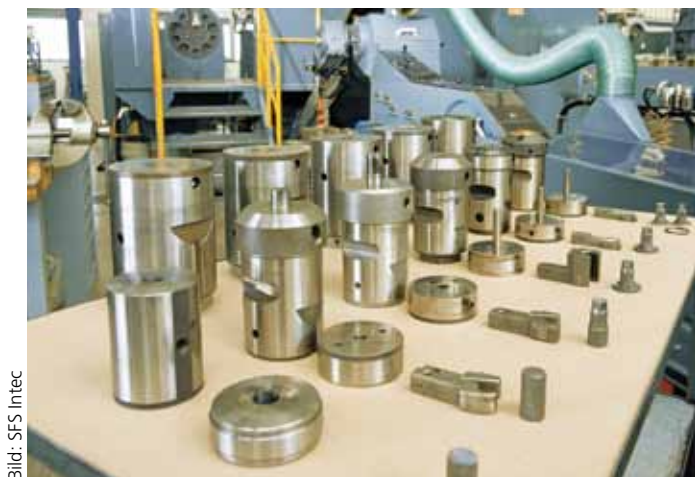
Der Werkzeugsatz einer Mehrstufenpresse kann bis zu 100 Einzelteile umfassen. Im Vordergrund der Stadiengang des Präzisionsformteiles. Die Werkstücke hierfür werden vom Werkzeugbau der SFS Intec gefertigt.
