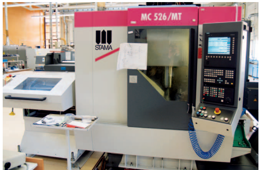
3 Fräs-Dreh-Zentrum für die Komplettbearbeitung von Einzelteilen und Kleinserien: Das Maschinenkonzept erweist sich mit einer Arbeitsspindel, die sowohl Fräs- als auch Drehwerkzeuge aufnimmt, als sehr rüstkundlich; die Bearbeitung an sechs Seiten wird mit Hilfe eines stabilen Werkstück-Schwenkgreifers realisiert
