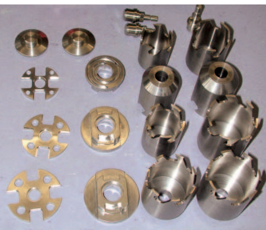
5 Junges Geschäftsfeld Orthopädie: Die medizinischen Instrumente und Implantate für Hüftoperationen sind stabiler dimensioniert als endoskopische Geräte; die Komplettbearbeitung auf der Stama MC 526 MT erübrigt nachfolgende Schleifarbeitsgänge
