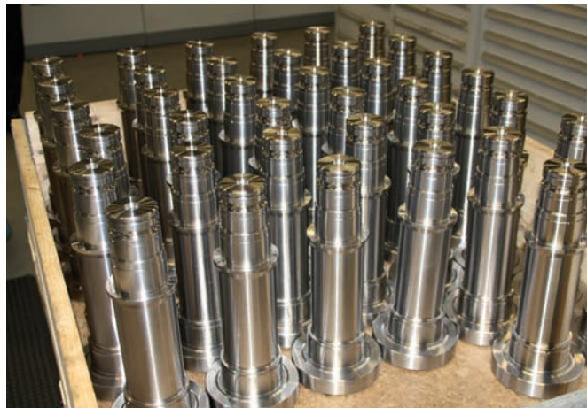
4 Fertigutteil: gedrehte, gebohrte und gefräste Antriebswellen, die für die Weiterbearbeitung bereits in der Zelle zu 100 Prozent vermessen wurden
