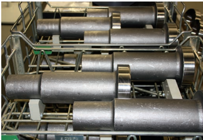
3 Rohteil: geschmiedete Antriebswellen-Rohlinge aus vergütetem Stahl mit bis zu 1100 N/mm 2 Zugfestigkeit und mit 2 bis 3 mm Aufmaß für die axiale Bearbeitung
