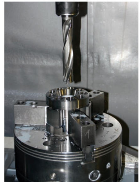
6 Zweite Spannung: horizontale und vertikale Bohr-/Fräsbearbeitung der Welle (bei jeweils optimal zum Kraftfluss ausgerichtetem Werkstück), anschließende Qualitätskontrolle in der Messstation, Korrekturwertübermittlung an die CNC und separate Gut-/Schlechtteil-Ablage des Fertigteils
